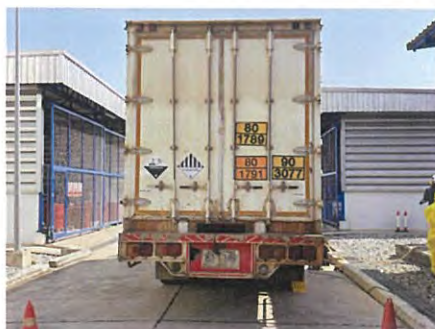
ภาพที่ 2-50 การติดตั้งเครื่องหมายและป้ายบนรถขนส่งสารเคมี
